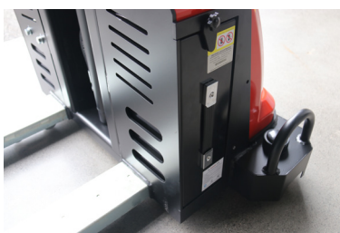
Accès à la batterie via trappe latérale
