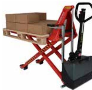
La mise à niveau automatique (en option) permet un travail à hauteur constant.
