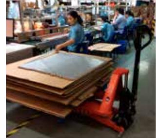
Le manuel nécessite peu de force pour la levée et propose une protection des pieds ainsi qu'une position neutre.
